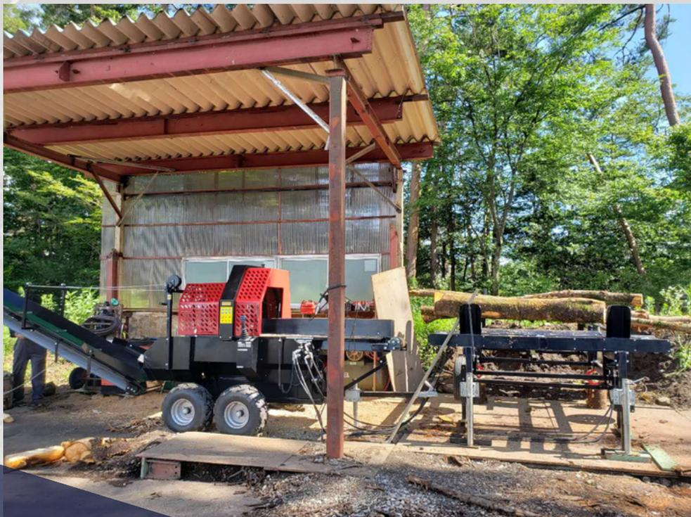
Ebenfalls im Lieferumfang enthalten ist ein **hydraulisch angetriebener 1,8 m langer Zuführtisch, sowie ein 3,5 m langes Förderband.**
